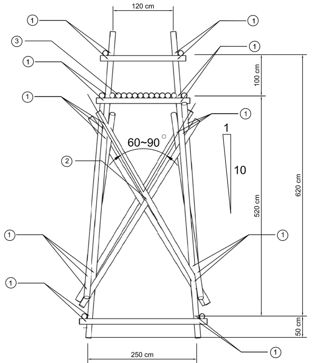
1. 方回結——兩木棍交接時，用方回結使其穩固，凡建設炊事架，工作臺等工程，需用此結。結法如圖 1。
